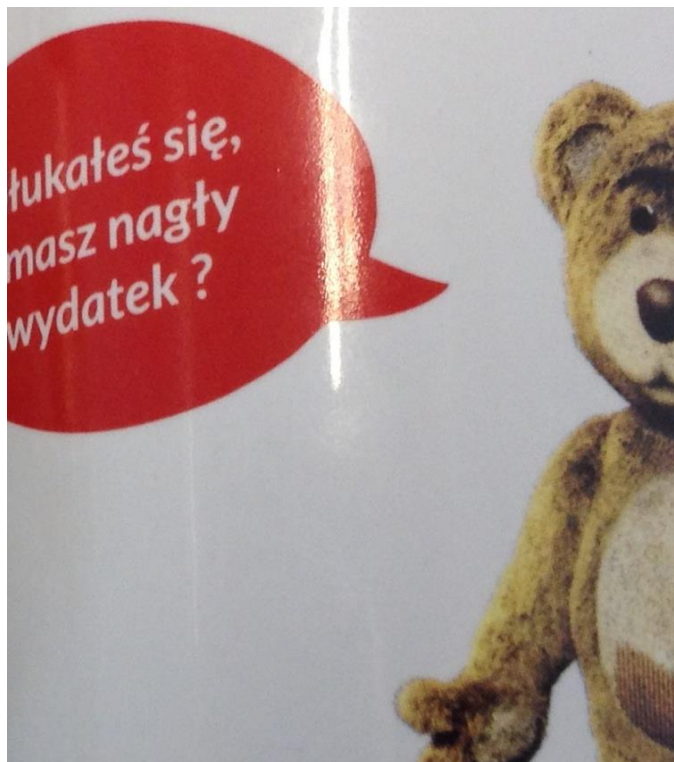
Druk CMYK + dodatkowa, czerwona farba według wzornika Pantone. Efekt: wyraźny, czerwony kolor zgodny z oczekiwaniami.
